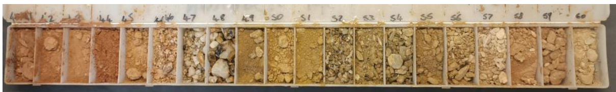
Photo 3 Hole NMWBRC20-101. 45m-50m. 5m @ 5.88g/t Au, incl. 3m @ 9.28g/t Au (45m-48m)
